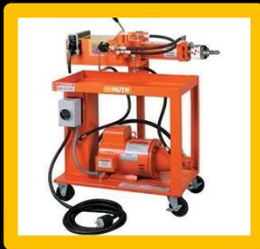
Modelo 1673: Expansor-reductor portátil para un moldeo versátil de extremos
