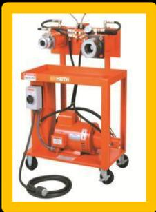
Expansor portátil modelo 1674 con dos potentes cilindros
